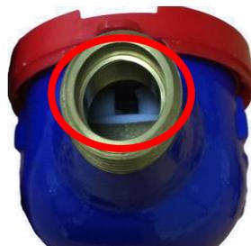
Periksa kondisi bagian *outlet* apakah dalam kondisi bersih dan tidak ada kotoran/benda menyangkut pada *measuring chamber*
